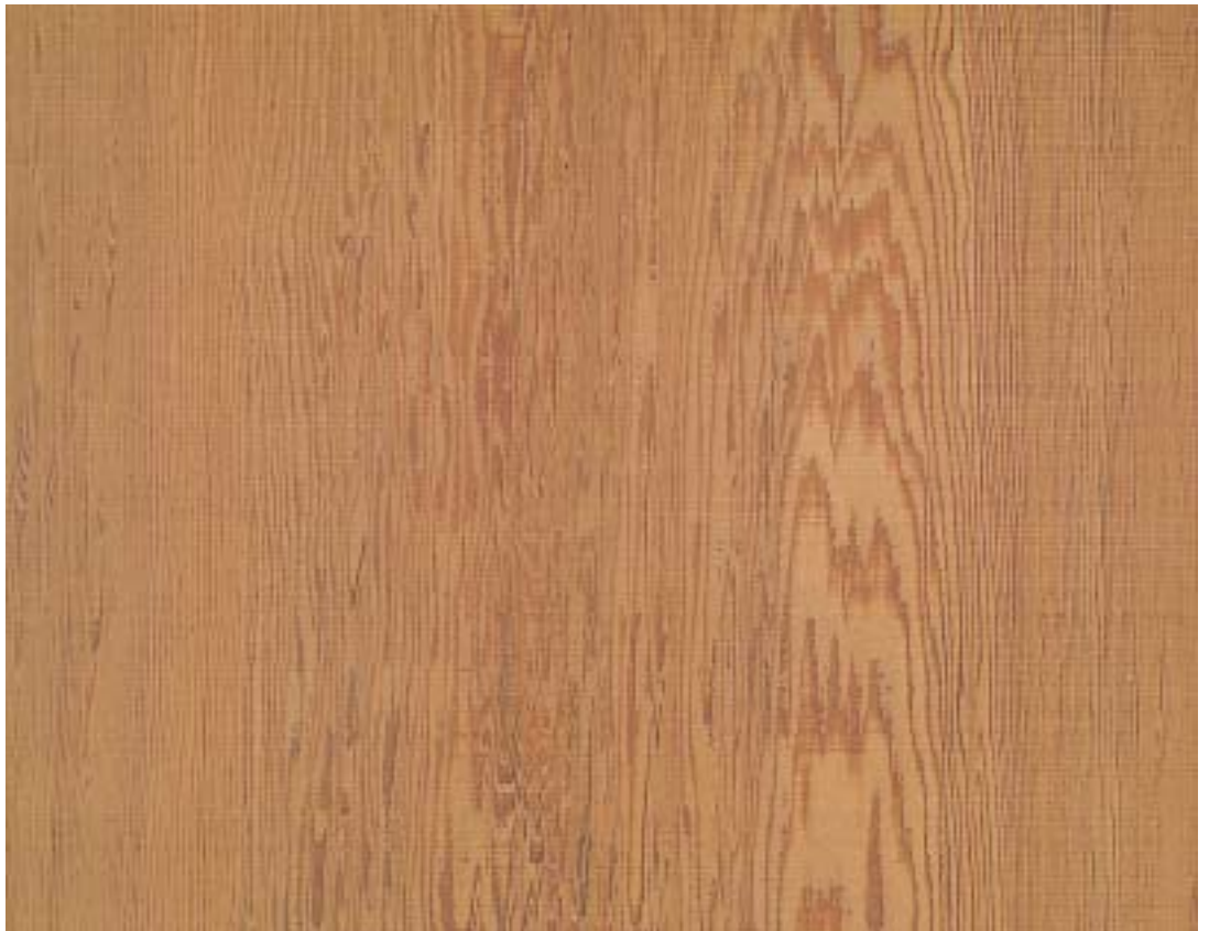
屋久杉天然杣（部分） 屋久島に産する杉は1000年以上の樹齢をもつものが多い。この杉からとれる天井板の美しさは昔から有名である。他の杉に比べて脂気の強いのが特色。
