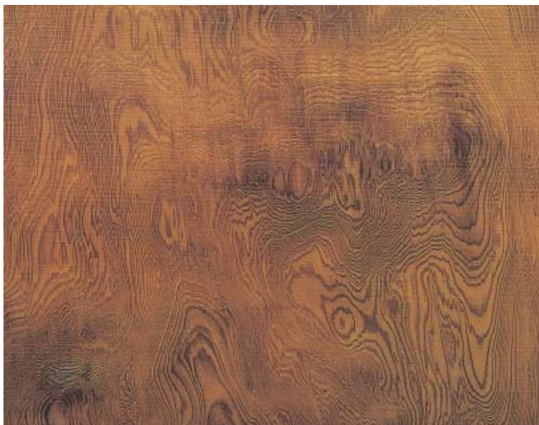
屋久杉全盛（部分） 屋久島は山が急峻なために、山で造材し人の背にかついで運び出す。そのため、特別の大きな材は得にくいのだが、この材は幅が1メートルあまりあり、すばらしい杢目を見せている。
