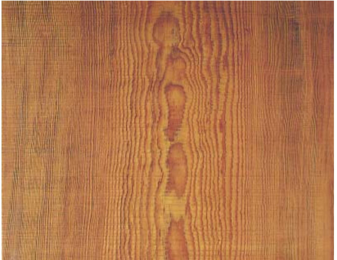
くろまつ（部分） 建築用材として松は、主に赤松と黒松であるが、地板に用いられるのはこの黒松である。黒松は雄松とも呼ばれ（赤松は雌松と呼ぶ）脂気が多いので肥松（こえまつ）脂松（やにまつ）ともいう。
