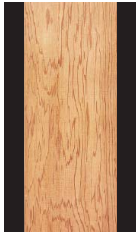
春日杉前立正角 奈良の春日神社の境内や春日山からとれる冬目、夏目とがはっきりとした赤味のある材。杣目が華やかで若干脂気があり、独特の艶がある。
